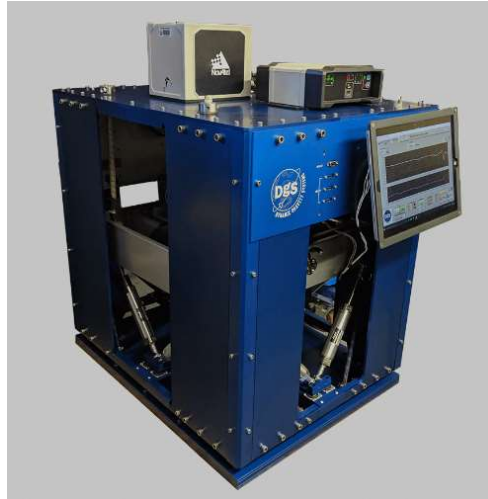
شکل ۳. نمونه ای از سیستم گرانشی هوابرد با فناوری پیشرفته (DGS)
